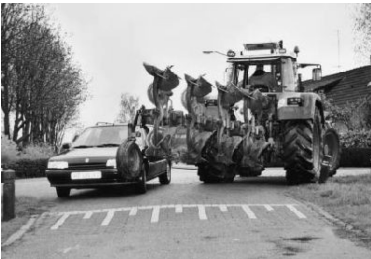
Figuur 1-19: Een ploeg zwaait naar buiten uit als je door een bocht rijdt.
