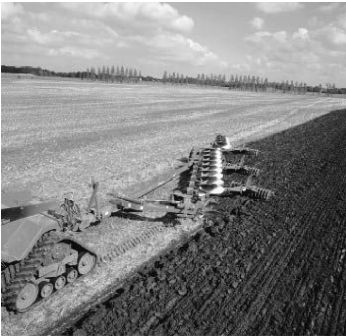
Figuur 1-3: Met het trekkerwiel rij je niet door de voor, maar bovenover.
