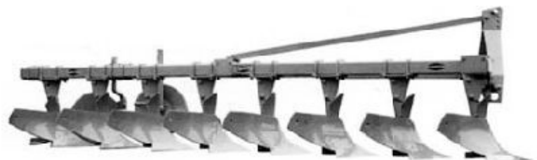
Figuur 1-7: Een stoppelploeg heeft kleine ploegelementen.
