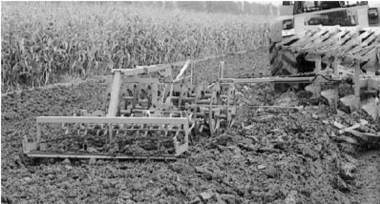
Figuur 1-15: Een vorenpakker wordt vaak door een ploeg meegetrokken.
