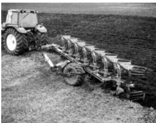
Figuur 1-5: Een halfgedragen wentelploeg heeft zes of meer scharen en een extra wiel.
