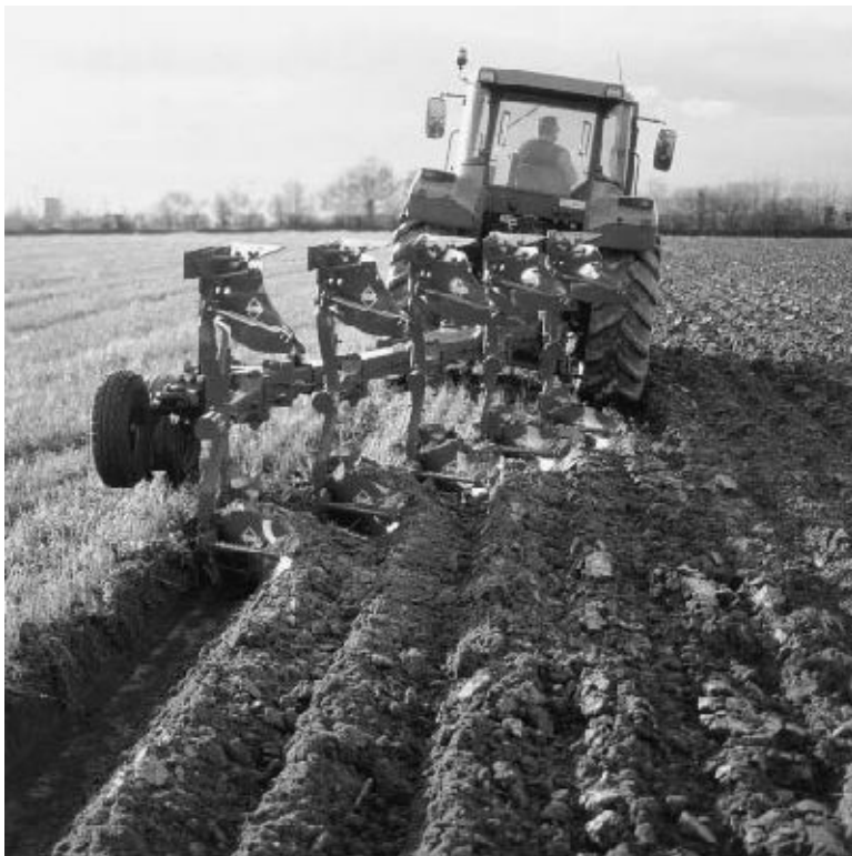
Figuur 1-4: Een aanbouwentelploeg wordt gekoppeld in de driepuntshefinrichting.
