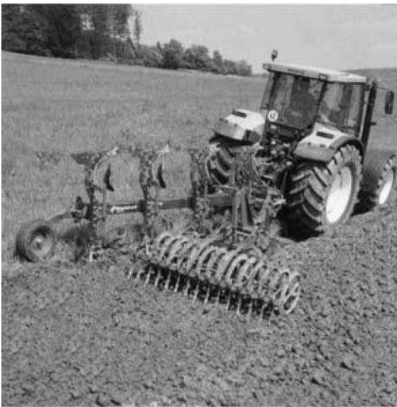
Figuur 1-16: Soms wordt de vorenpakker aan de ploeg bevestigd.
