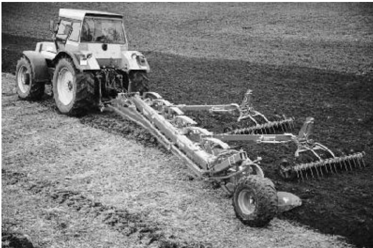
Figuur 1-2: Rondgaande ploegen worden gebruikt voor de hoofdgrondbewerking.
