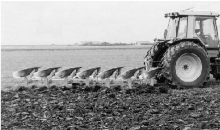
Figuur 1-6: Ecoploegen is een ondiepe bewerking.
